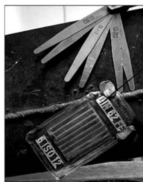
Рис. 3. Тестові об'єкти: зварені сталеві пластини, набір щупів та набір залізних дротиків (див. таблицю)
