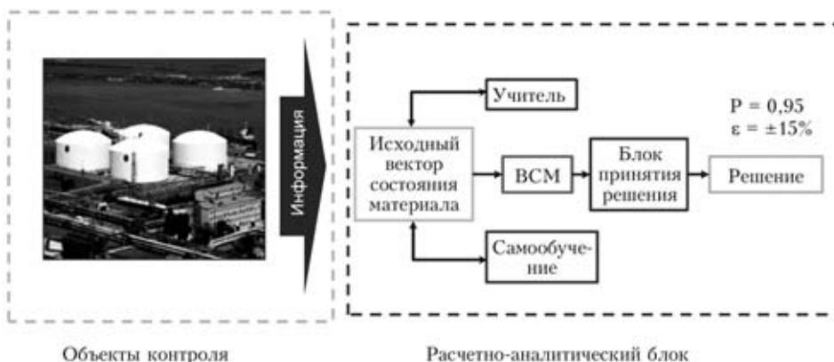
Рис. 6. Адаптивная система распознавания состояния материалов
