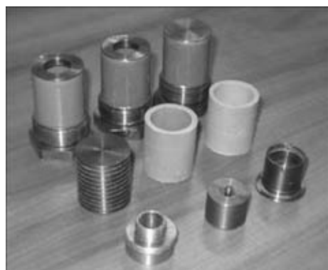
Рис. 2. Зовнішній вигляд основних деталей корпусів ПП (діаметр керамічних циліндрів 30 мм)
