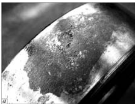
Рис. 3. Следы фреттинг-коррозии на посадочной поверхности наружного (а) и внутреннего (б) колец шарикоподшипника
