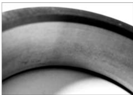
Рис. 2. Матовая поверхность внутреннего кольца подшипника при неподвижной посадке на вал
