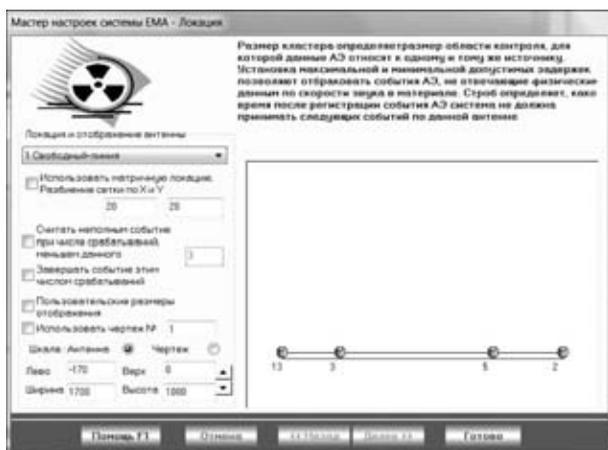
Рис. 5. Экран мастера настроек системы ЕМА-3. Реализована возможность управления формированием событий (флажки для включения-выключения и поле ввода для установки минимального и максимального числа срабатываний)
