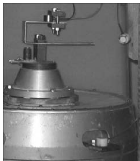
Рис. 2. Внешний вид акустического тракта системы для измерения параметров АЭ листовых материалов в процессе резонансного нагружения образцов
