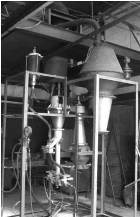
Рис. 2. Лабораторная установка УСИ-20 с АЭ мониторингом производительностью 20 кг/ч
