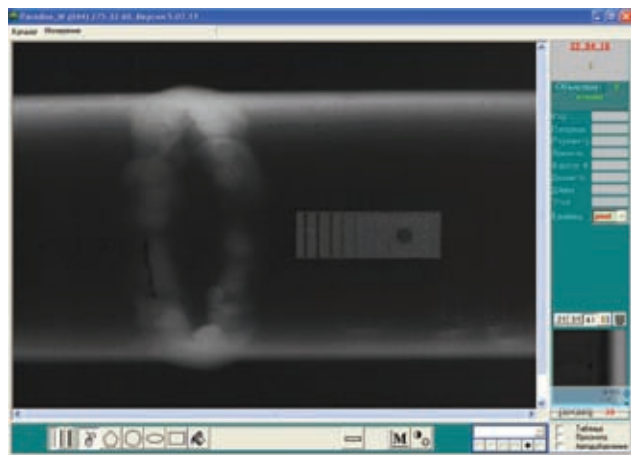
Цифровое рентгентелевизионное изображение сварного соединения трубы на экране компьютера
