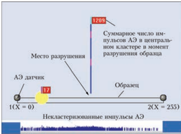
Рис. 2. Распределение сигналов АЭ по длине образца при испытаниях растяжением. В нижней части графика представлено распределение сигналов АЭ без кластеризации
