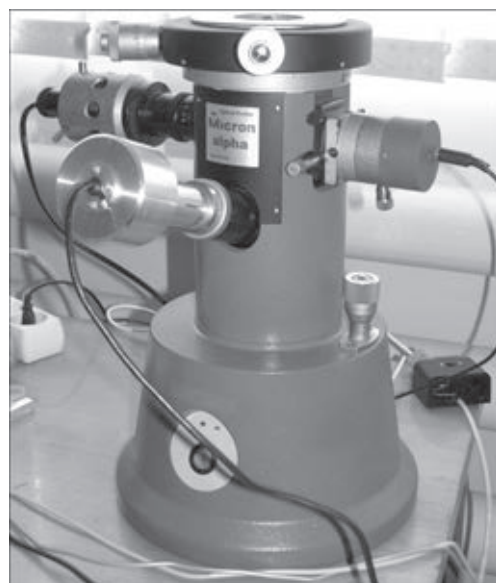
Рис. 5. Безконтактний інтерференційний тривимірний профілометр «Мікрон-альфа»
