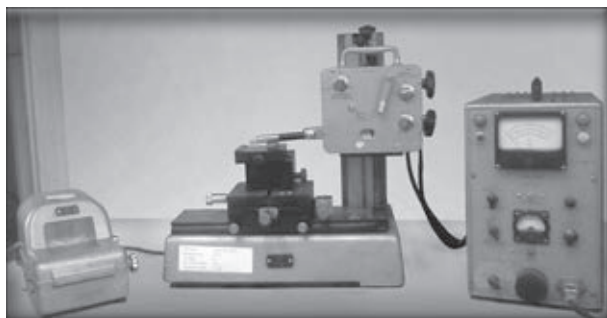
Рис. 2. Профілограф-профілометр для визначення шорсткості та хвилястості поверхонь
