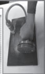
3. Многопрофильные намагничивающие устройства, адаптируемые к любым геометрическим особенностям поверхности контроля. Сменные полюсные наконечники крепятся на матрице и повторяет профиль поверхности.
