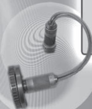
6. Намагничивающие устройства с подвижным полюсом в виде катка. Предназначено для контроля в поисковом режиме при любых конфигурациях изделий. Второй полюс может быть неподвижным или комплектоваться роликовой платформой.
