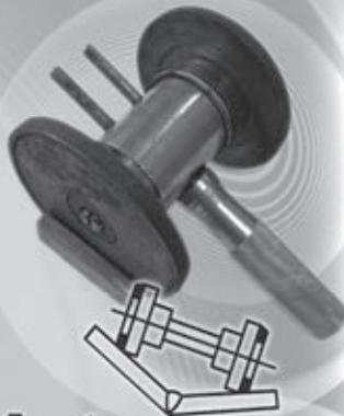
1. Намагничивающие устройства со сменными дискообразными магнитными полюсами и дополнительными полюсными элементами. Подвижность и разнонаправленность намагничивания обеспечивает новые технологические возможности, позволяет снизить трудоёмкость процесса контроля, повысить производительность и выявляемость дефектов. Возможны поисковый и оценочный режимы обнаружения индикаций.
