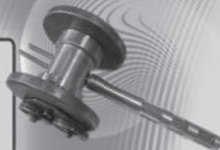
8. Намагничивающее устройство с выдвинутой зоной локального намагничивания. Предназначено для магнитопорошкового контроля протяженных объектов больших площадей, например, днищ резервуаров и т.п.
