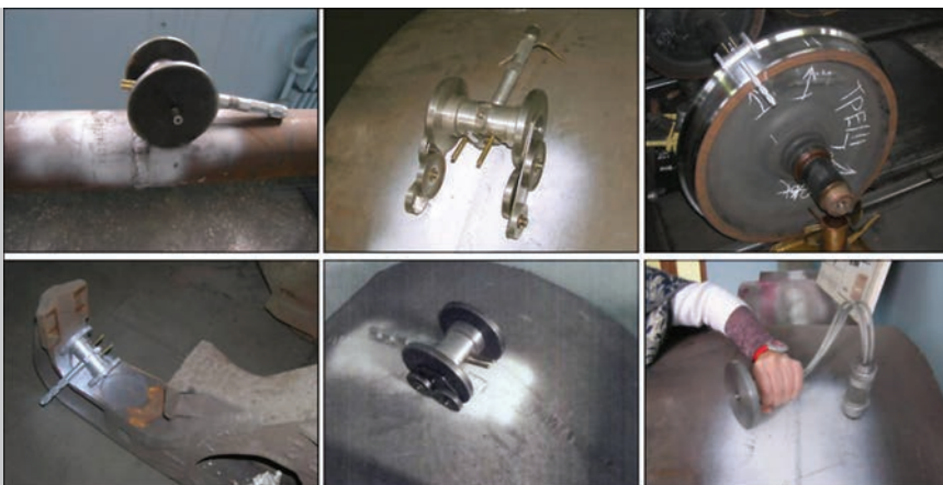
Устройства для разнонаправленного подвижного локального намагничивания металлоконструкций при поиске в них трещин
