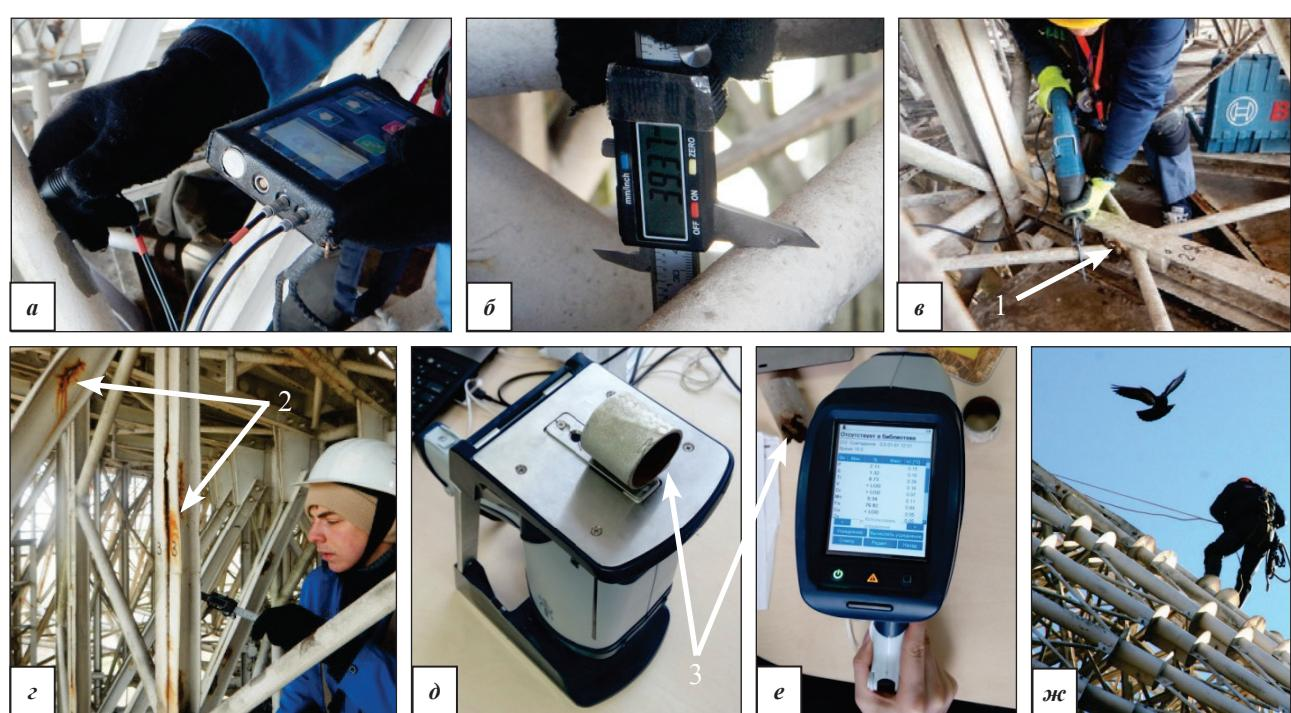
Выявление дефектных элементов конструкций (а–жс) на этапе инструментального обследования: 1 – разрыв несущего элемента; 2 – скрытая коррозия элементов; 3 – марка стали не соответствует требованиям действующих норм проектирования
