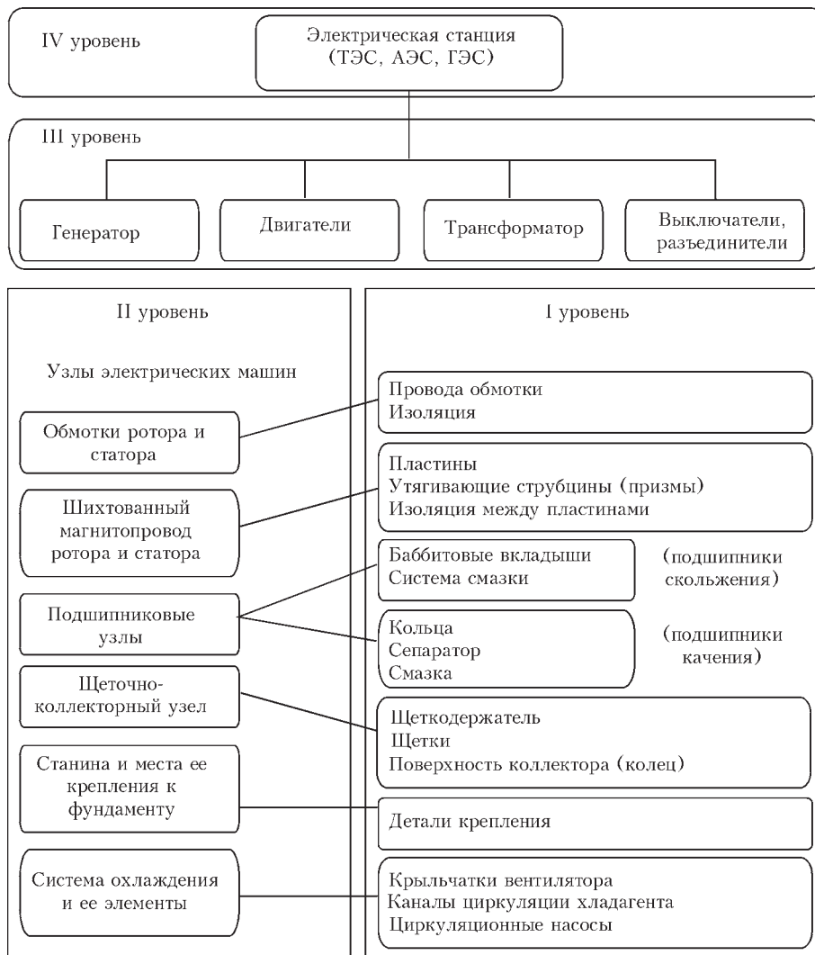
Рис. 3. Условная структура энергетического оборудования теплоэнергетической системы
