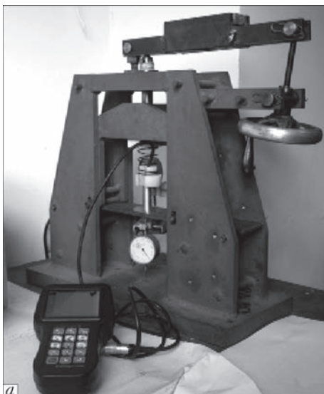
Рис. 1. Експериментальна установка для чотириточкового навантаження з вихрострумowym дефектоскопом типу ВД 3-81 (а) по схемі чистого згину (б): c = 100 ; d = 200 мм
