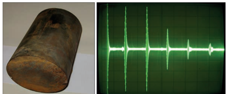
Рис. 4. Образец железнодорожной оси и соответствующая реализация обегаящих по окружности импульсов в отсутствие поверхностного дефекта
