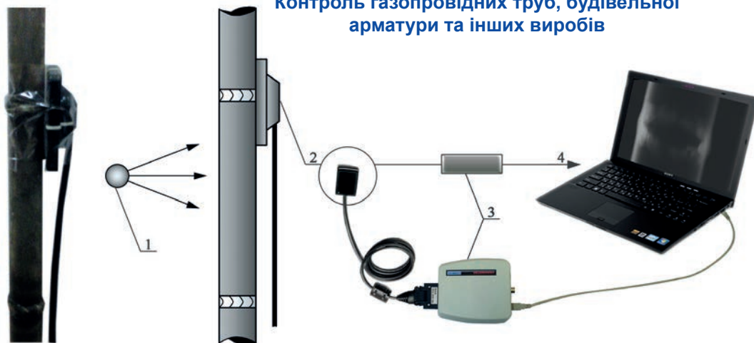
1 – джерело радіаційного випромінювання; 2 – мініатюрний твердотільний перетворювач; 3 – блок передачі цифрових зображень; 4 – передача зображень на екран монітора
