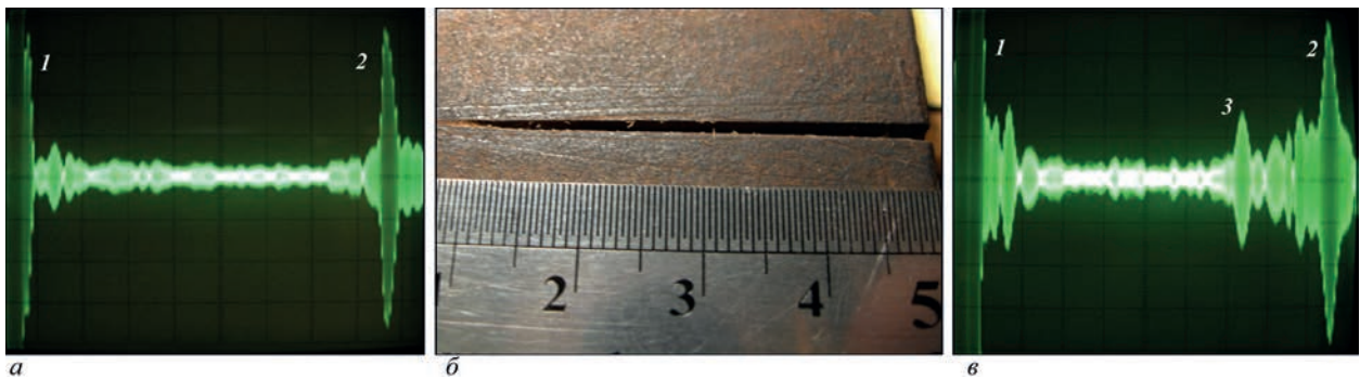
Рис. 2. Реализации для случаев бездефектного участка (а) листа из стали 09Г2С и при наличии поверхностного дефекта (в) в виде риски (б) размерами 35×1×2,2 мм (описание 1–3 см. в тексте)
