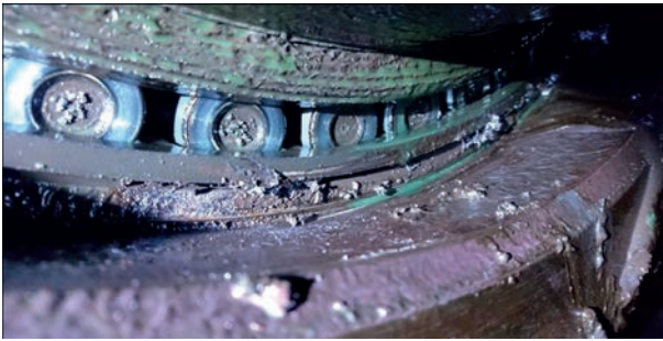
Рис. 8. Подшипник 97770. Повреждение сепаратора. Клеть 6
