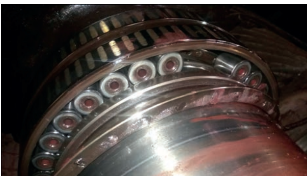
Рис. 5. Подшипник 97773. Повреждение внутреннего дистанционного кольца. Клеть 8
