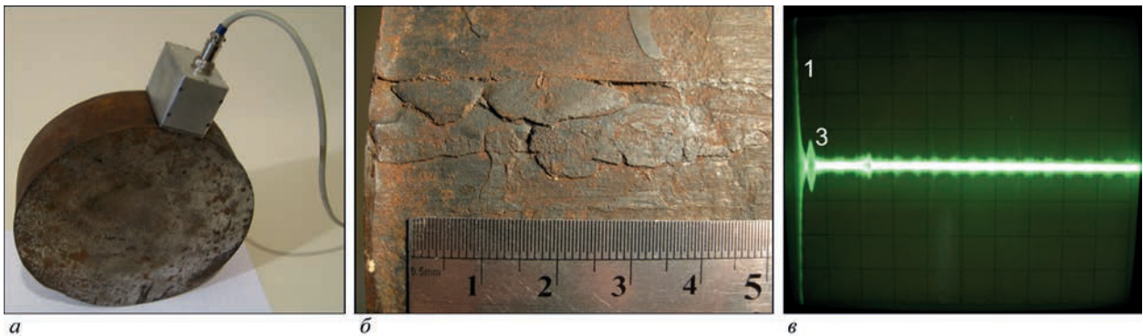
Рис. 6. Образец из заготовки круглого сечения (а), фото естественного дефекта (б) и реализация с эхо-импульсом от этого дефекта (в) (описание 1, 3 см. в тексте)
