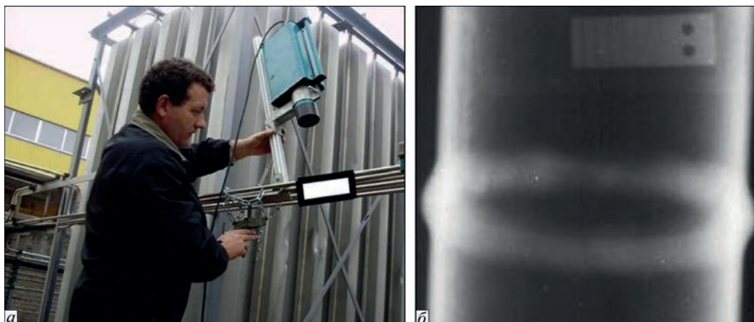
Рис. 3. Рентгентелевизионный НК с помощью твердотельного миниатюрного R-преобразователя четырехниточного трубопровода на Киевском кислородном заводе (а) и рентгенограмма сварного соединения фрагмента трубы, просвеченной через две стенки (б)
