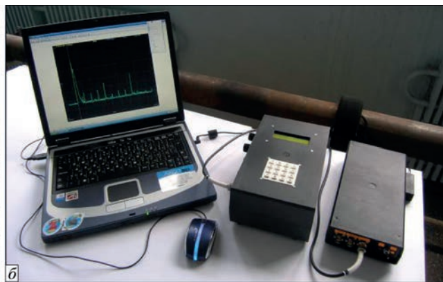
Рис. 9. Антенны дефектоскопов НЧ УЗК «Универсал-2П» 16 кГц (а) и «Универсал-1П» 36 кГц (б) на технологических трубопроводах диаметром 330 (а) и 154 мм (б)
