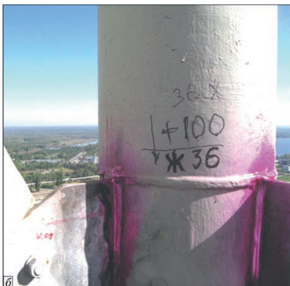
Рис. 14. Старая и новая вентиляционные трубы (а) четвертого реактора ЧАЭС. Капиллярный контроль элементов каркаса новой вентиляционной трубы Чернобыльской АЭС (б)
