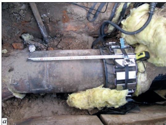
Рис. 9. Антенны дефектоскопов НЧ УЗК «Универсал-2П» 16 кГц (а) и «Универсал-1П» 36 кГц (б) на технологических трубопроводах диаметром 330 (а) и 154 мм (б)
