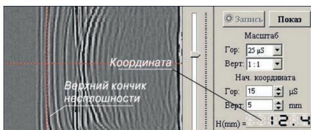
Рис. 10. Пример измерения в сварном соединении трещины методом TOFD
