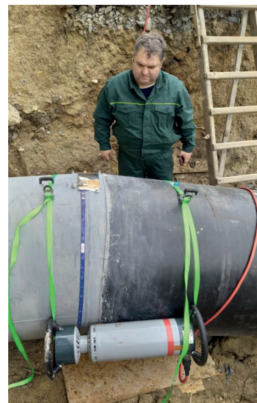
Рентгенографічний контроль трубопроводу, 2021 р.
