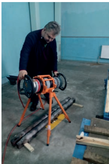
Виконання робіт з радіографічного контролю вузлів авіаційного обладнання, 2021 р.
