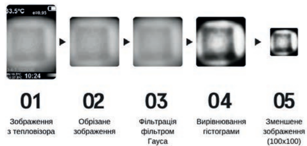
Рис. 2. Алгоритм попередньої обробки теплового зображення у вигляді прямокутника
