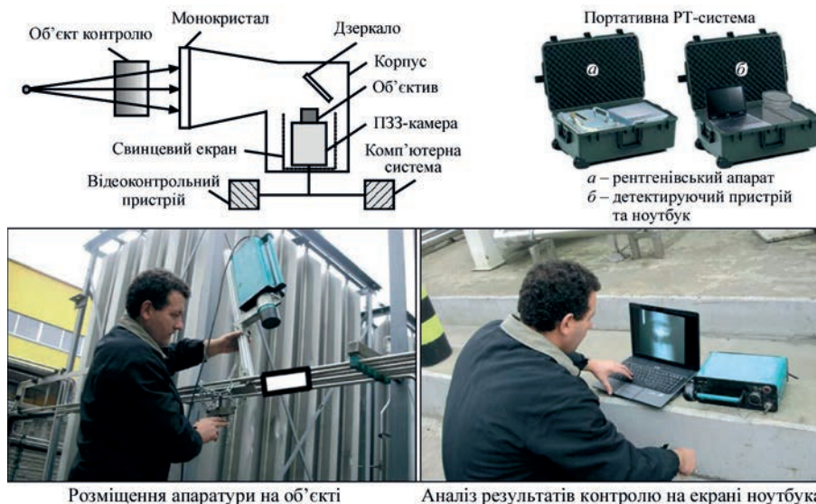
Рис. 6. Портативне цифрове рентгенотелевізійне обладнання
