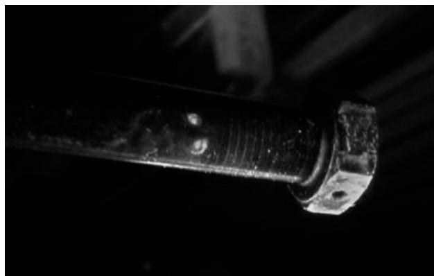
Fig. 1. Schematic indication of cracks on a propeller mounting bolt Рис. 1. Індикація (сліди) тріщин на болті кріплення повітряного гвинта.
