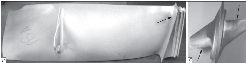
Рис. 10. Лопать вентилятора з зонами контролю хвостовика (а) і антивібраційних полиць (б)
