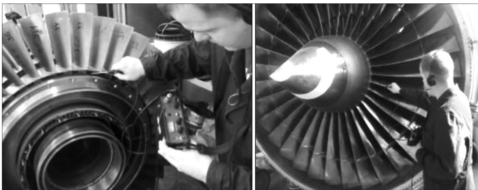
Рис. 9. Контроль деталей АД дефектоскопом ЛЕОТЕСТ ВД 3.03Н
