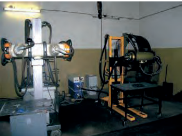
Стационарні рентгенівські апарати РУП 150/300 і «Екстрасоль-360» в рентгенівській лабораторії ІЕЗ ім. Є.О. Патона НАНУ
