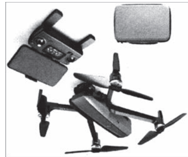
Рис. 2. Дрон MJX D16 Pro, оснащений великим набором датчиків, відеокамерою, бортовим комп'ютером та ін.
