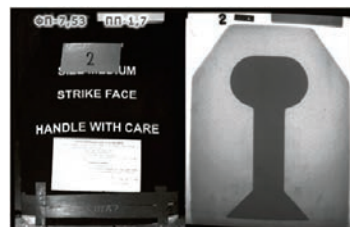
Рис. 2. Зовнішній вигляд (ліворуч) бронепластина та її рентген-телевізійне цифрове зображення (праворуч)
