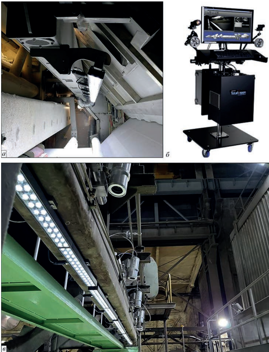
Рис. 6. Автоматизована система WebInspector: а – балкова конструкція; б – портативна; в – конструкція типу WebView [24, 25]
