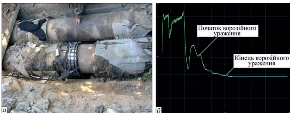
Рис. 4. Контроль підземної ділянки діючої теплотраси (а) та осцилограма луно-сигналу від корозійно ураженого трубопроводу (б)
