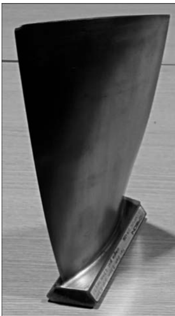
Рис. 1. Типова лопатка компресора газової турбіни з електроерозійним прорізом завдовжки 4 мм, завглибшки 0,2 мм і розкриттям 0,1 мм у зоні галтельного переходу для налаштування та перевірки технології контролю
