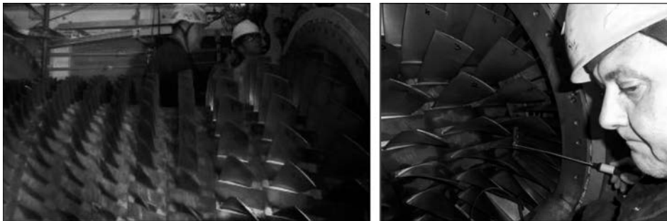
Рис. 9. Виробничі випробування запропонованої технології вихрострумове контролю лопаток газових турбін
