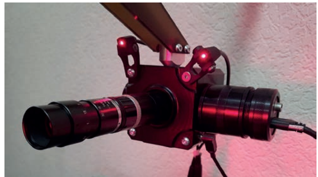
Рис. 2. Зовнішній вигляд широкографічного інтерферометра із лазерними модулями та змінним об'єктивом
