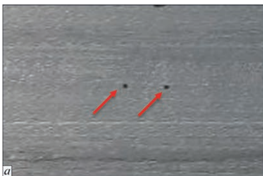
Рис. 8. Ширографічний контроль досліджуваної ділянки зварного шва алюмінієвого зразка: загальний вигляд ділянки з дефектами (а) і типова картина виявлених дефектів діаметром d = 0,3 мм і завглибшки L = 0,35 і 0,85 мм (б)
