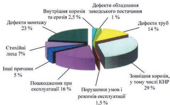
Рис. 1. Основні причини відмови трубопроводів
