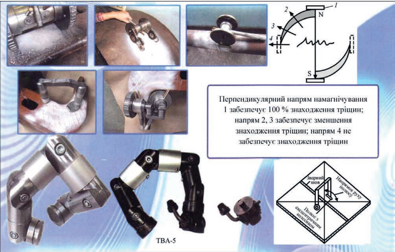
Рис. 6. Скануючі пристрої ІЕЗ ім. Є.О. Патона для магнітопорошкового контролю
