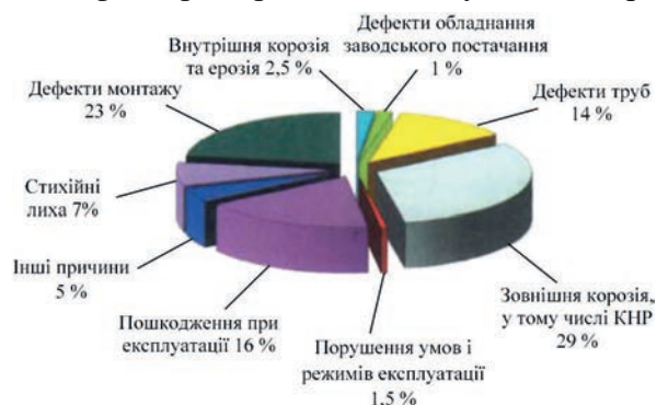
Рис. 1. Основні причини відмови трубопроводів
