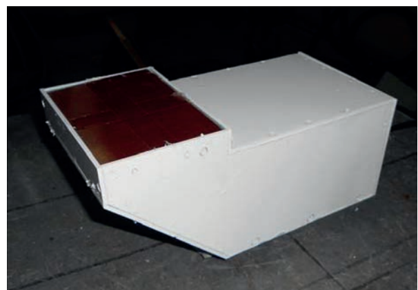
Рис. 4. Зовнішній вигляд РТВС на основі КМОН-сенсора MT9M034 і рентгенівського екрану Gd2O2S(Tb) для контролю зварних з'єднань трубопроводів малого діаметра
