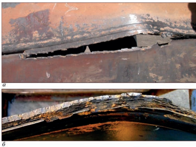
Рис. 9. Злам труби зі сталі X70 біля осередку корозійної тріщини, що утворилася під час експлуатації МГ розміром 1420 \times 15,7 мм
