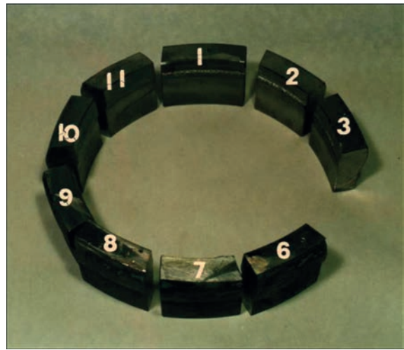
Рис. 10. Загальний вигляд зварного з'єднання приварювання днища 1РГК-8, ст. 177, розрізаного на темплеті. Верхня частина темплетів звернена у бік труби РГК, нижня – у бік днища
