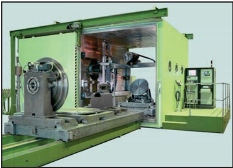
KL 115 mashine: 36 m³, 60 kV, up to 60 kW
