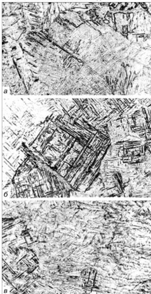
Рис. 3. Микроструктура ( \times 400 , уменьш. 4/5 ) металла ЗТВ: а — дуговая; б — электронно-лучевая; в — лазерная сварка
