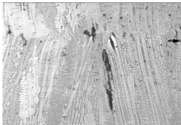
Рис. 8. Горячие трещины в швах стали IN 840 (X200, уменьш. 2/5)
