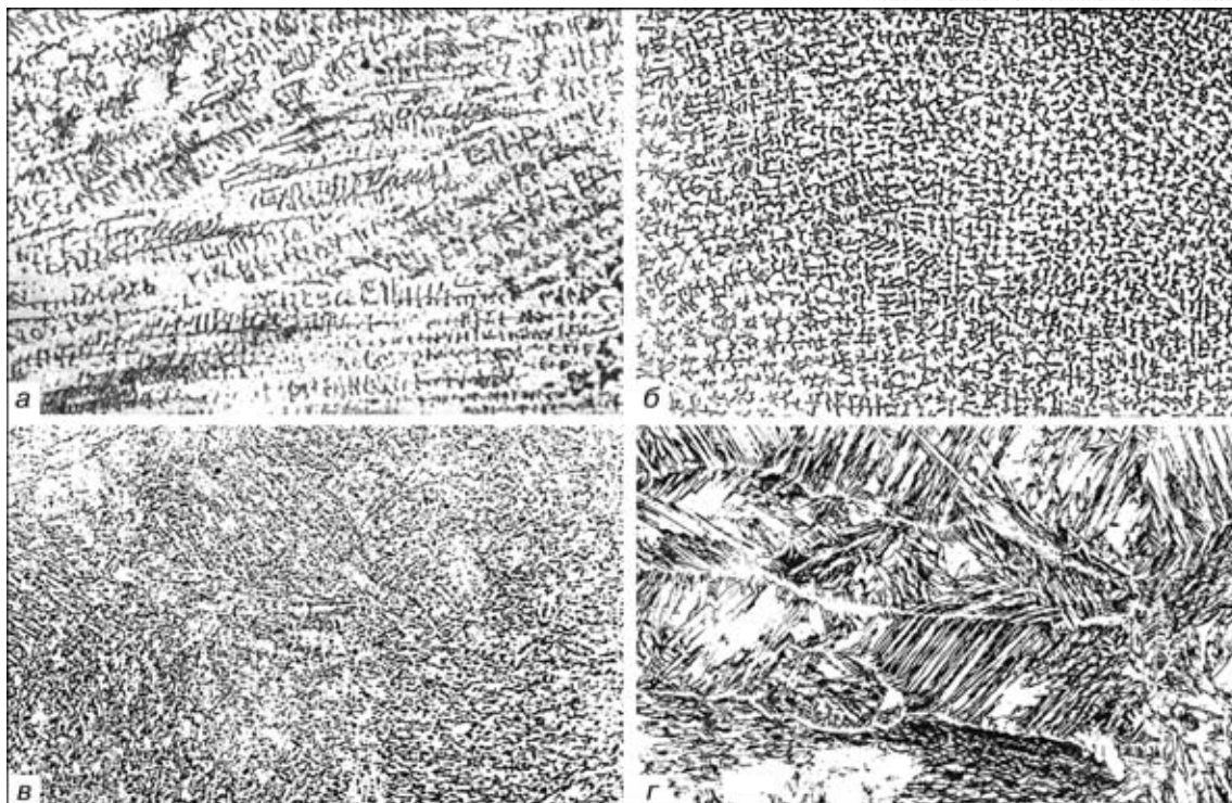
Рис. 3. Микроструктуры металла швов различных сталей, выполненных способом сварки А-ТИГ: а — Fe-19Cr-9Ni (304L); б — Fe-18Cr-13Ni (316L); в — Fe-16Cr-4Ni; г — Fe-23Cr-6Ni-MoTi
