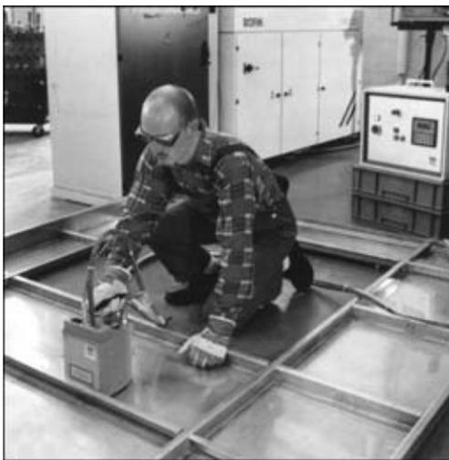
Рис. 2. Лазерная сварка листовых конструкций с помощью переносного аппарата LHSG-1
