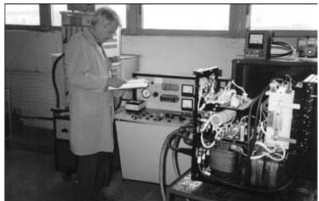
Рис. 1. Станция приемо-сдаточных испытаний готовой продукции
