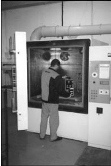
Рис. 2. Контрольные испытания готовой продукции в испытательной лаборатории
