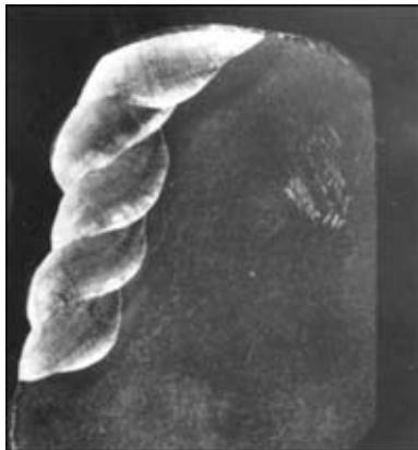
Рис. 1. Макрошлиф наплавленной губы рельса
