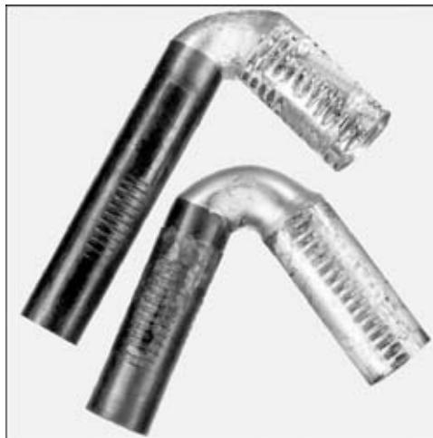
Рис. 6. Соединения ( $P_u = 40 \dots 60$  МПа,  $P_{ap} = 200$  МПа,  $t_u = 0.4$  с,  $t_r = 0.7$  с) после механических испытаний на ударный загиб
