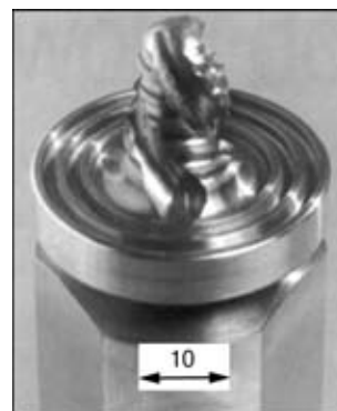
Рис. 13. Прототип инструмента с торговым знаком MX Triflute™
