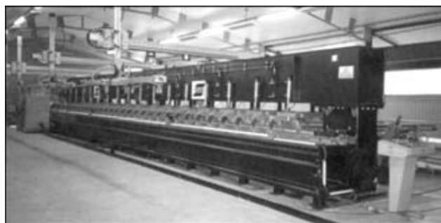
Рис. 20. Установка ESAB Super Stir™ для сварки прессованных панелей, поставленная на фирму «Marine Aluminium» (Норвегия)
