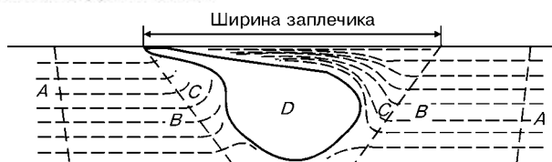
Рис. 19. Схема зон стыкового соединения, выполненного СТП: А — основной металл; В — зона термического влияния; С — зона термомеханического влияния; D — зона динамической рекристаллизации
