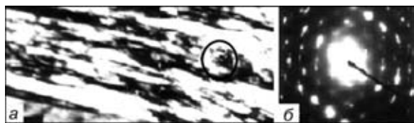
Рис. 3. Тонкая структура зоны сварки никеля ( a ), полученная сваркой взрывом при \alpha = 20^\circ , и соответствующая микродифракционная картина рефлексов ( б ), \times 15000
