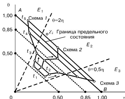
Рис. 1. Различные схемы протекания технологических процессов, представленные в системе координат  $\theta\eta$
