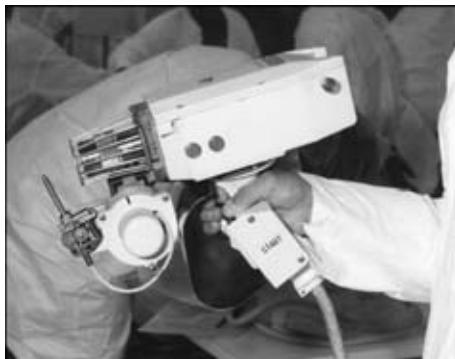
Рис. 9. Защитный экран ЭЛП ручного инструмента
