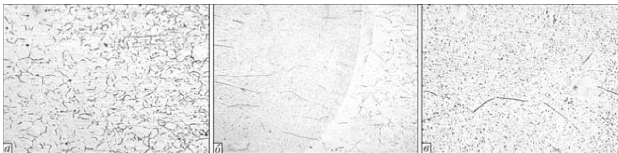
Рис. 7. Микроструктура сварного соединения сплава 32НКА, выполненного электронно-лучевой сваркой, на участке перехода от зоны рекристаллизации к металлу шва: а — зона рекристаллизации вблизи шва, \times 150 ; б — зона сплавления, \times 150 ; в — металл шва, \times 250
