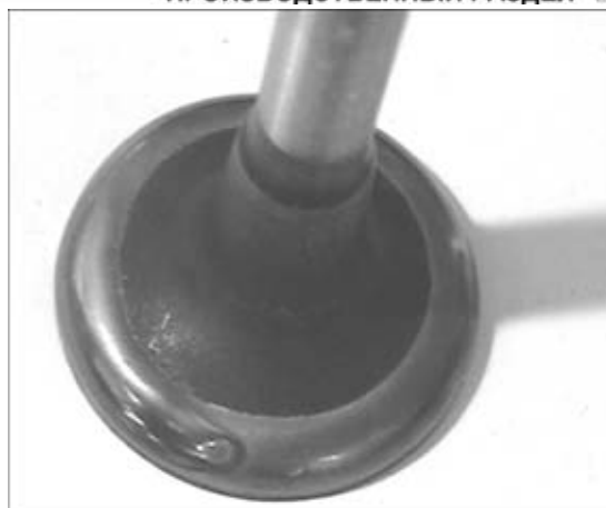
Рис. 7. Клапан дизельного двигателя с твердым слоем сплава I типа, наплавленного плазменной дугой прямого действия
