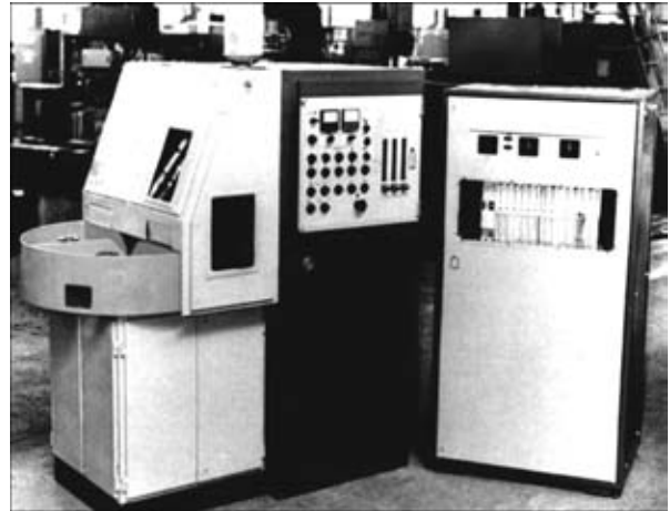
Рис. 12. Автоматическая установка УП142 для наплавки деталей арматуры
