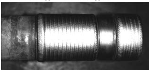
Рис. 9. Поршень для бурения нефтяных скважин, наплавленный плазменной дугой прямого действия сплавом Stellite 712
