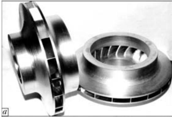
Рис. 18. Внешний вид сваропаяных рабочих колес центробежного компрессора из высокопрочной нержавеющей стали (а); макрошлиф сваропаянского соединения, полученного ЭЛС и пайкой в вакууме (б), [32, 33]
