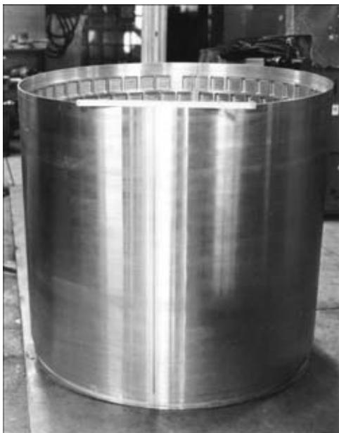
Рис. 3. Внешний вид фрагмента крупногабаритной обечайки из сплава АМг6 диаметром 1145 мм и толщиной свариваемых кромок 90 мм
