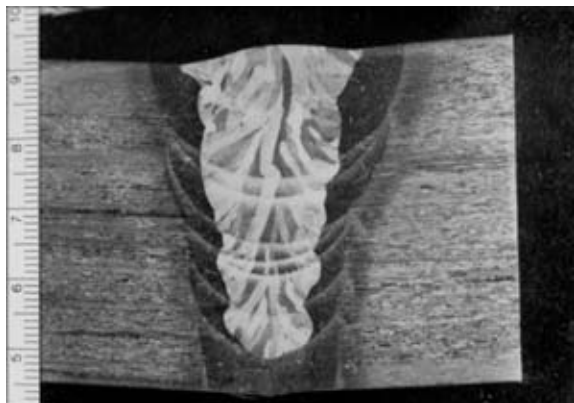
Рис. 2. Макрошлиф стыкового сварного соединения толщиной 30 мм, выполненного двухдуговой сваркой с присадкой
