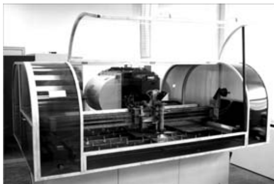
Рис. 3. Автоматизированный технологический комплекс для лазерной резки с компьютерным управлением на базе модернизированного \text{CO}_2 -лазера «Хебр-1А»
