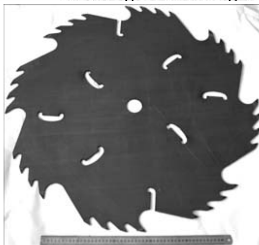
Рис. 5. Корпус дисковой пилы диаметром 800 мм из листа стали 65Г толщиной 5 мм
