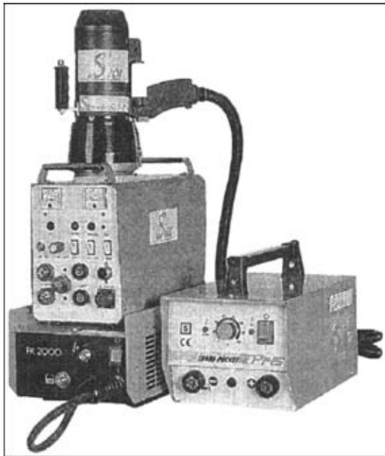
Рис. 1. Комплект светолучевого оборудования для сварочного роботизированного комплекса
