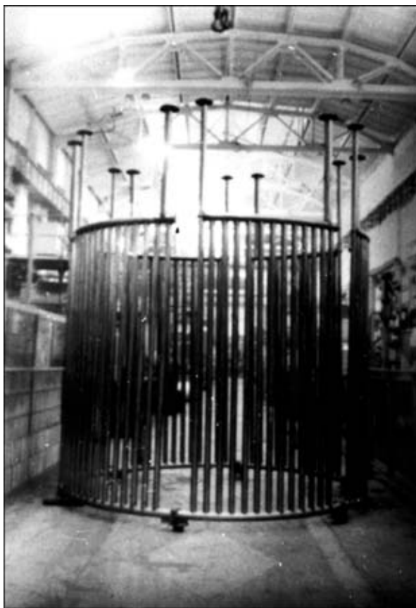
Рис. 3. Сварной трубный теплообменник-подогреватель из сплава Э125
