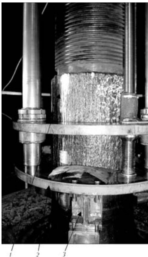
Рис. 2. Устройство для механической обработки наплавленных поверхностей вала конуса: 1 — вал дробящего конуса; 2 — планшайба; 3 — резцедержатель
