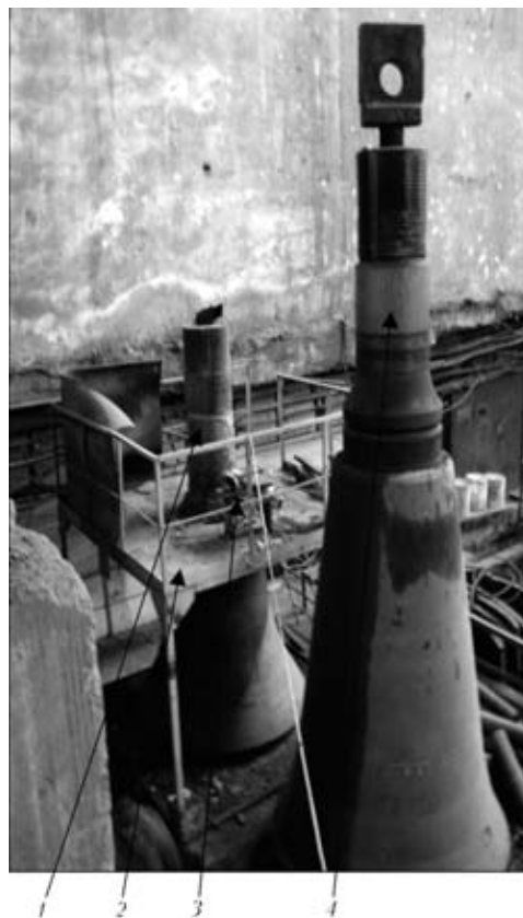
Рис. 3. Участок восстановления валов конусов: 1 — конус до восстановления; 2 — площадка для выполнения наплавки; 3 — полуавтомат ПШ107В; 4 — конус после восстановления вала
