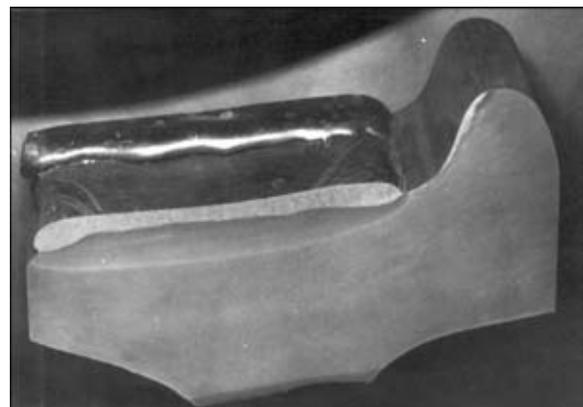
Рис. 3. Фрагмент обода колеса с наплавочной поверхностью
