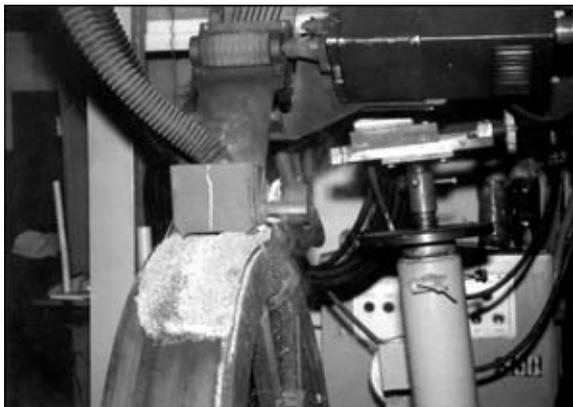
Рис. 2. Установка УНО-2 для наплавки ободьев колес
