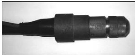
Плазменный резак с воздушным охлаждением установки «Днепр»
