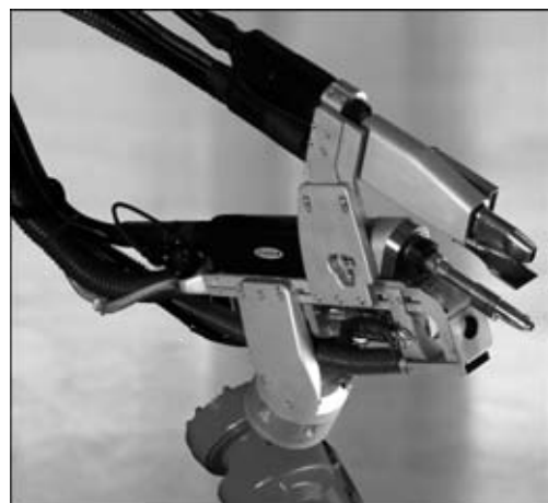
Рис. 2. Сварочный модуль (инструмент) для осуществления гибридной лазерной сварки МИГ/МАГ + сварка двумя последовательными дугами
