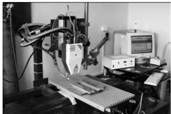
Рис. 2. Внешний вид экспериментальной установки для лазерной сварки алюминиевых сплавов с использованием ВДЛ ROFIN DL 020
