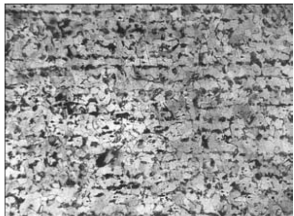
Рис. 1. Микроструктура (×200) стали 09Г2С в состоянии поставки
