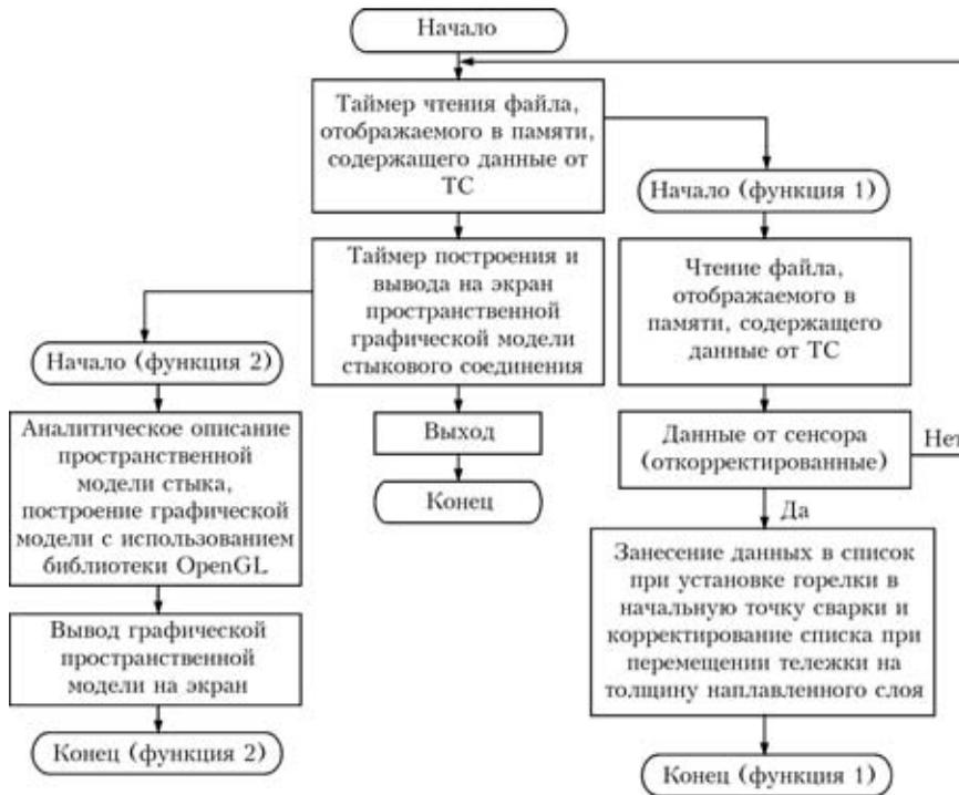
Рис. 4. Блок-схема алгоритма построения пространственной модели стыка
