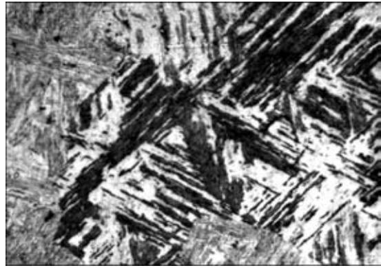
Рис. 1. Микроструктура стали 03X12H8M2ГСТ (прототип металла шва),  $\times 500$
