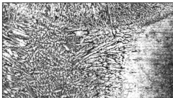
Рис. 2. Первичная микроструктура металла двухслойного шва (×50)
