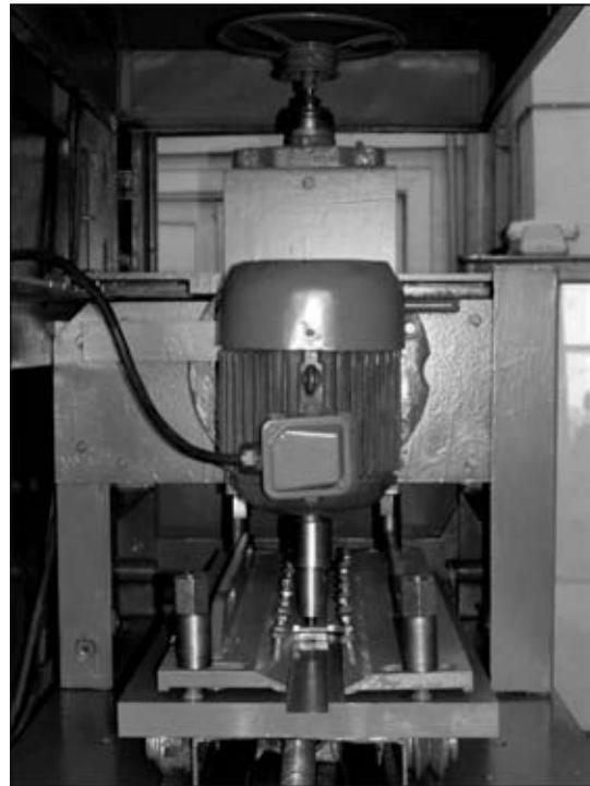
Рис. 2. Внешний вид лабораторной установки для СТП тонколистовых (1,8...2,5 мм) алюминиевых сплавов
