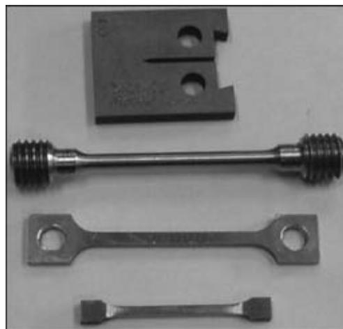
Рис. 2. Образцы для разных видов испытаний
